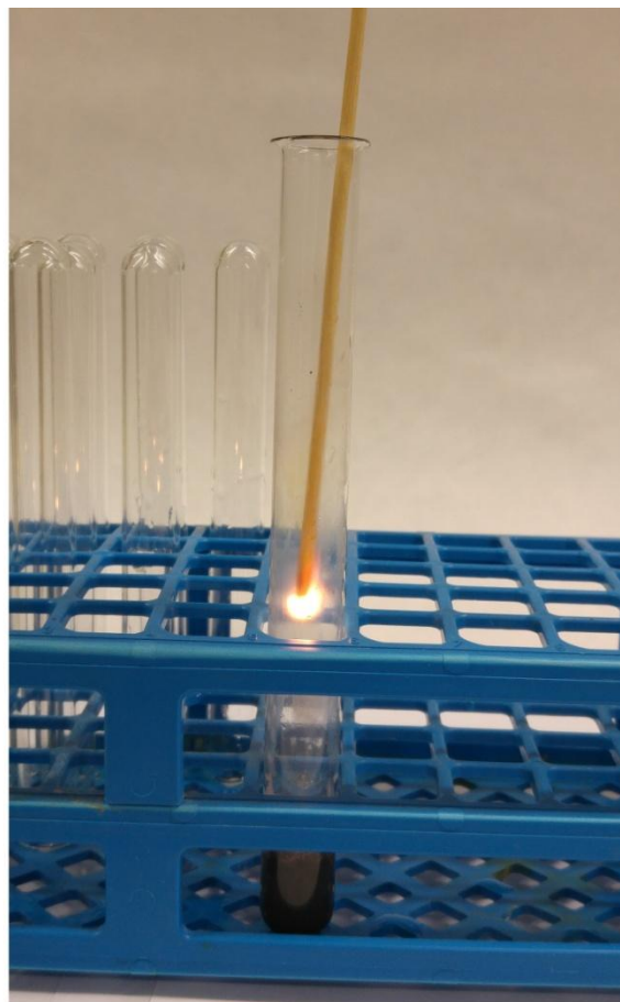
Obr. 3 Příprava kyslíku – a) doutnající špejle ve zkumavce, b) hořící špejle
