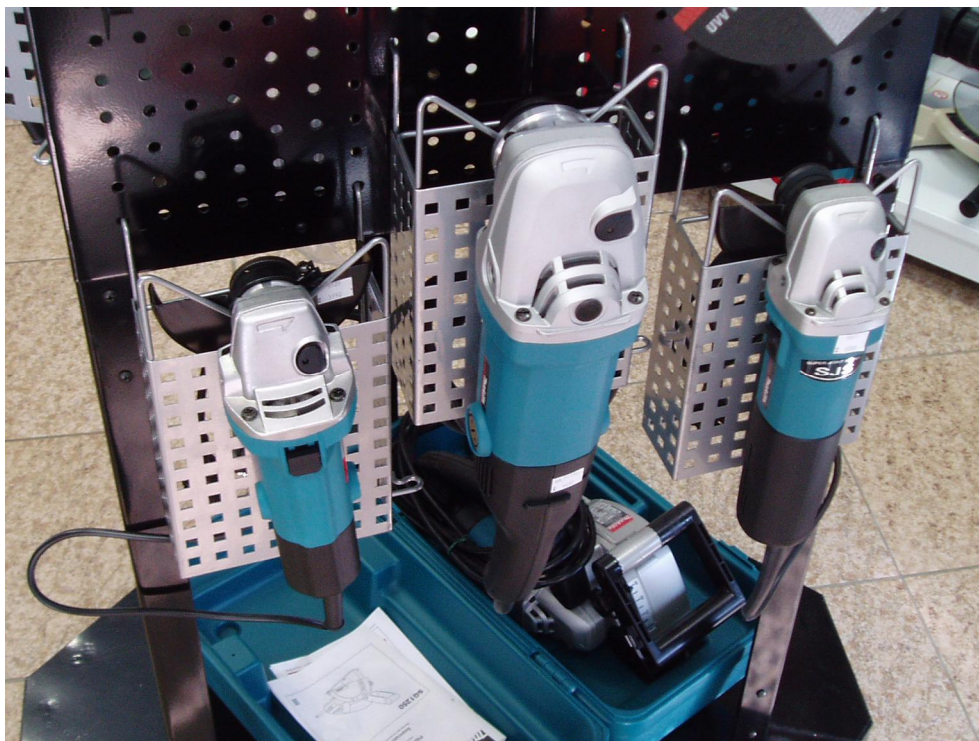
Obr. 9. Detail uchycení úhlových brusek firmy Makita
