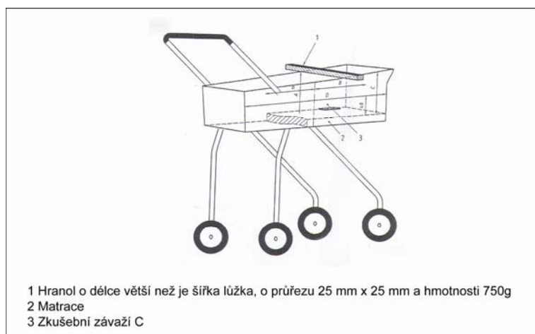
Obr. 14. Měření minimální vnitřní výšky lůžka.
