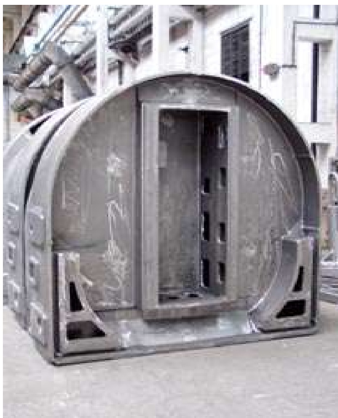
Obrázek 5 Odlitek šedé litiny
