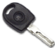
Obr. 1. Klíč se sériově zabudovaným imobilizérem
