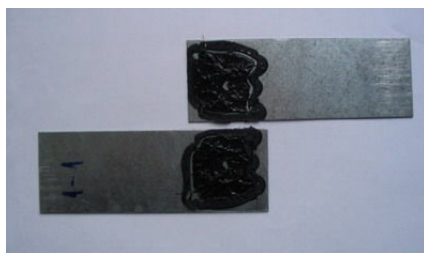
Obr. 48. Spôsob porušenia lepidla Terostat-9220
