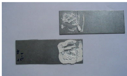
Obr. 49. Spôsob porušenia lepidla Terostat-8596
