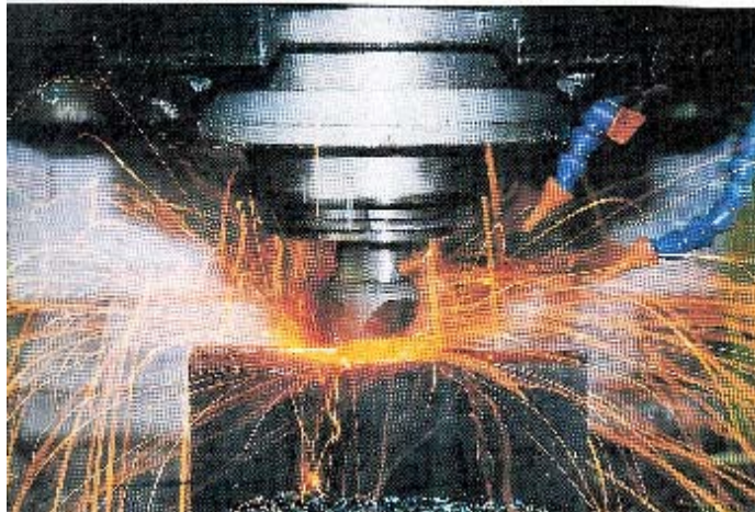
Obr. 1 : Vysokorychlostní, suché a tvrdé hrubovací frézování povlakovanými karbidy[18]
