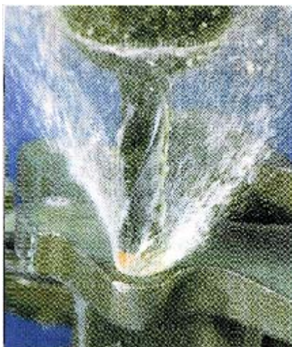
Obr. 6 : Vysokorychlostní „mokré“ vrtání s intenzivním odplavováním třísek (fa. Seco). [18]
