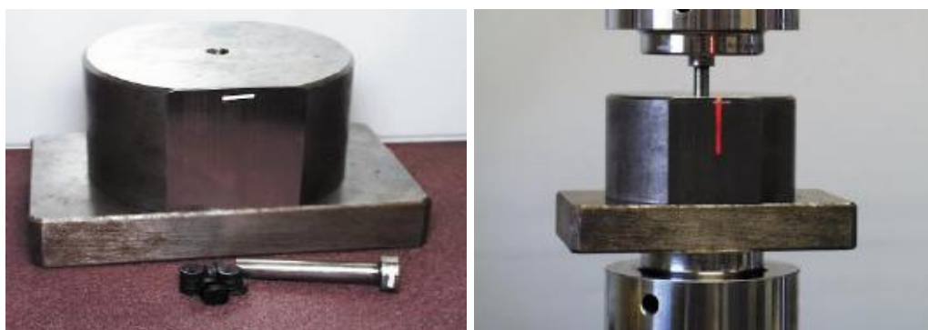
Obr. 9 Zkouška objemové stlačitelnosti
