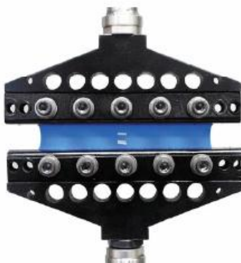
Obr. 8 Zkouška čistého rovinného smyku
