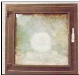
Obr. 8. Vnitřní strana okna Sälzer po výbuchu nálože umístěné v bezprostřední blízkosti. Lidé by zůstali nezraněni a okno stále poskytuje dostatečnou ochranu proti násilnému vniknutí
