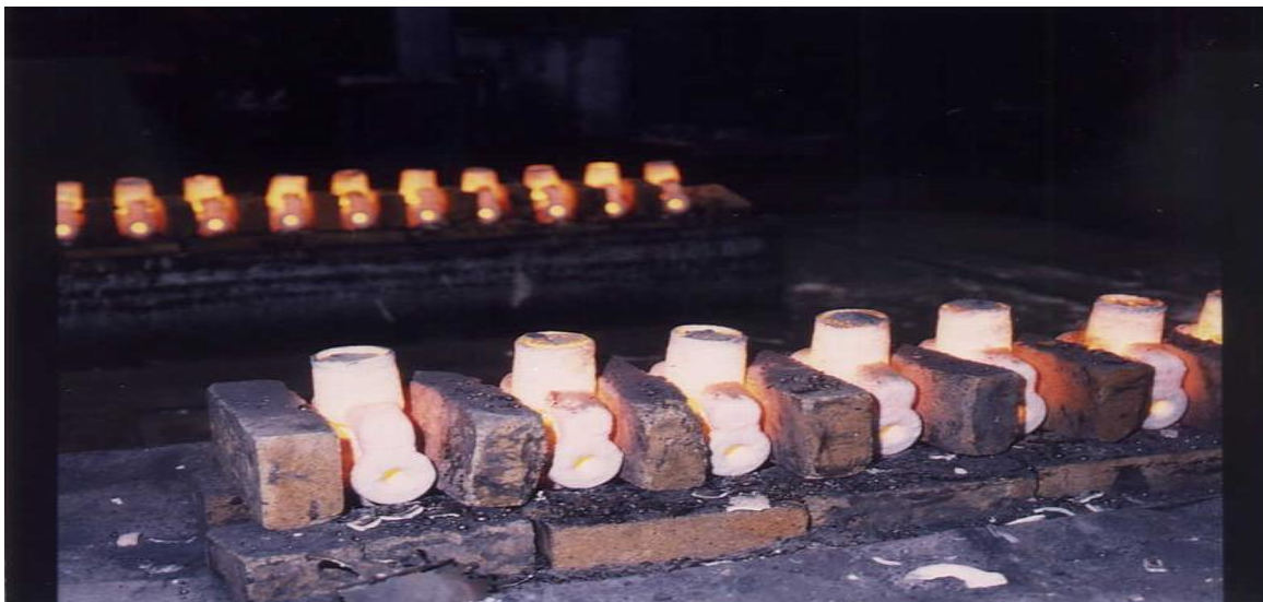
Obr. 9 - Odlitek těsně po odlití [13]
