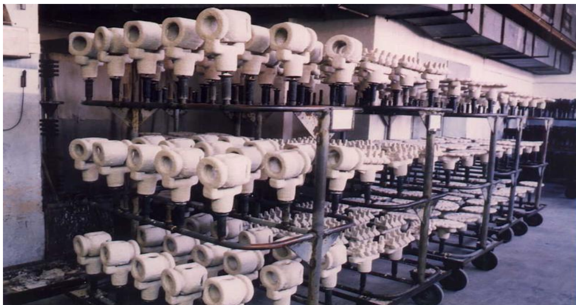
Obr. 8 - Sušení obalů skořepin [13]
