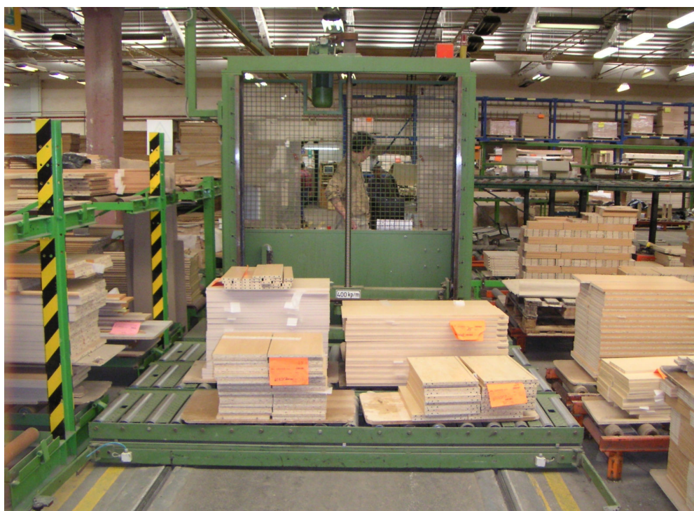
Obr. 7. Přeprava materiálu kolejovým vozíkem [Vlastní zpracování]
