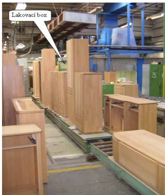
Obr. 33. Kompletace na válečkové trati [Vlastní zpracování]
