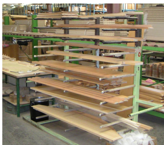
Obr. 15. Stojany na přemontované dílce [Vlastní zpracování]
