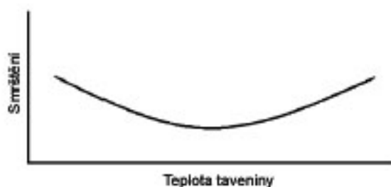
Obr. 28. Závislost velikosti smrštění na teplotě taveniny [2]
