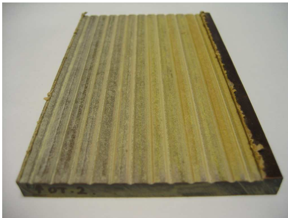
Obr. 33. Destička reaktoplastu plněného papírem, dvoubřitý nástroj
