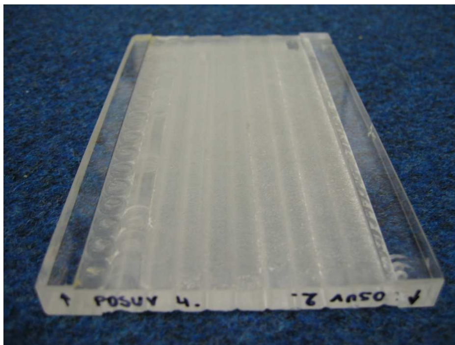
Obr. 47. Destička z PMMA frézovaná čtyřbřitým nástrojem
