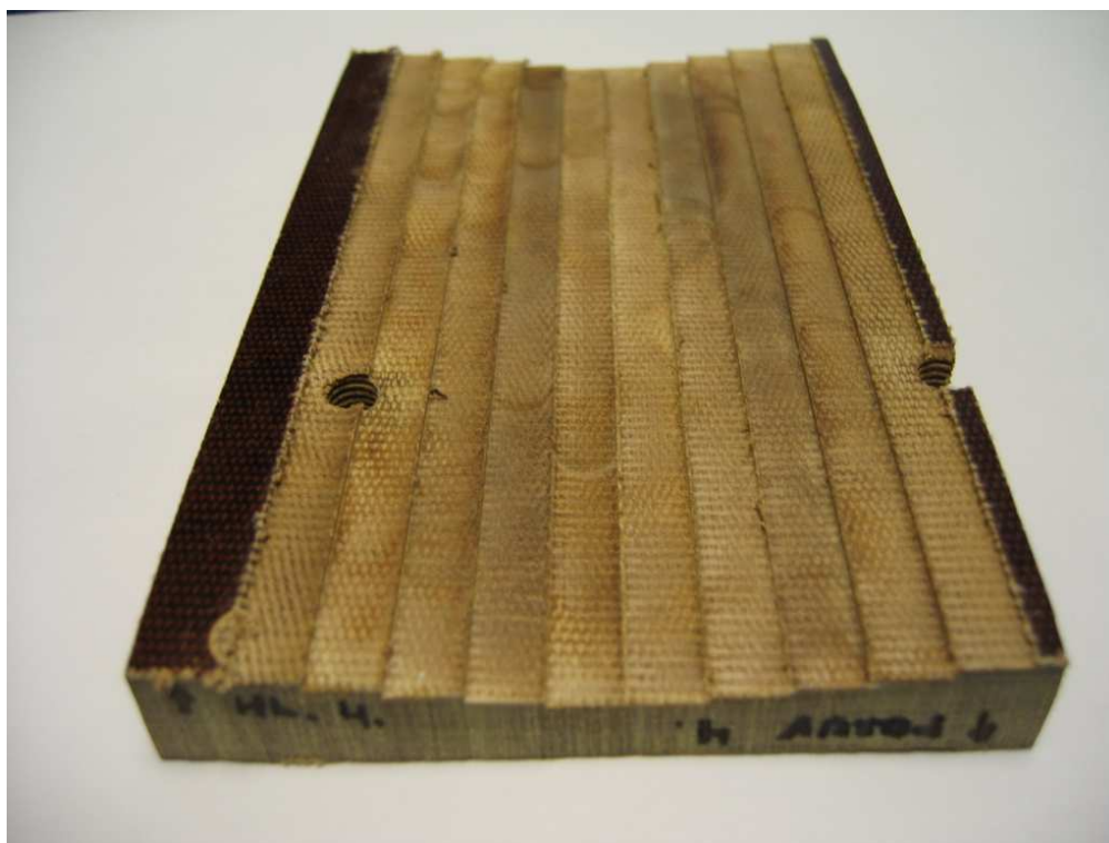
Obr. 62. Destička z reaktoplastu plněná textílem
