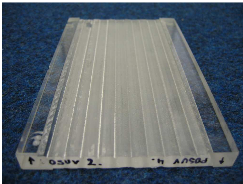
Obr. 45. Destička z PMMA frézovaná dvoubřítým nástrojem
