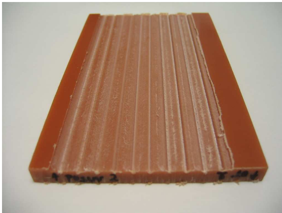
Obr. 41. Destička z PVC frézovaná dvoubřítým nástrojem
