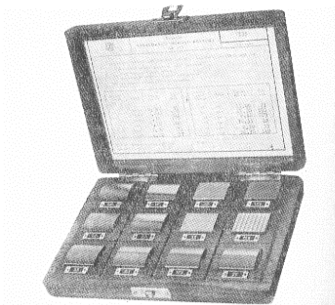
Obr. 15. Vzorkovnice drsnosti povrchu
