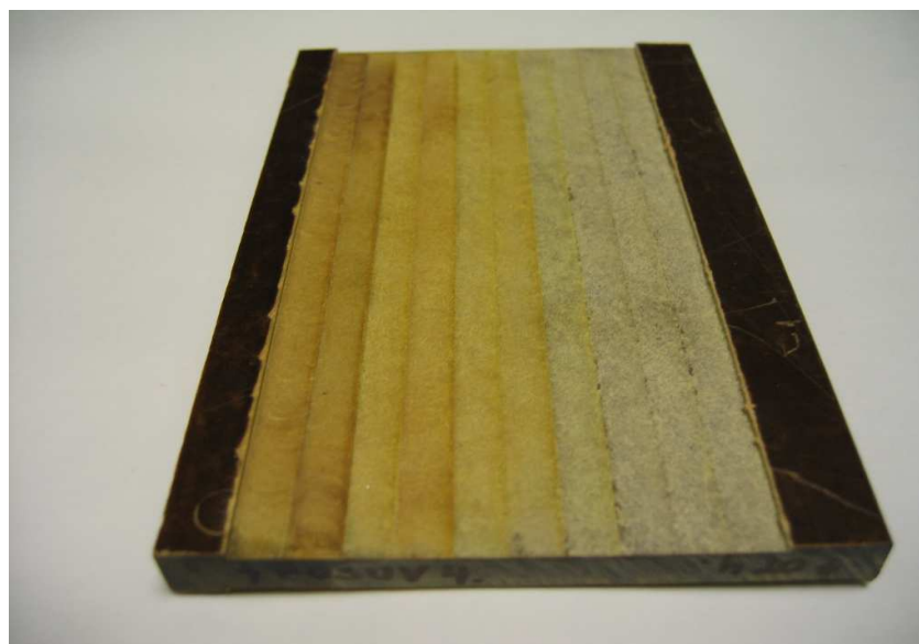
Obr. 51. Destička reaktoplastu plněná papírem, čtyřbřítý nástroj
