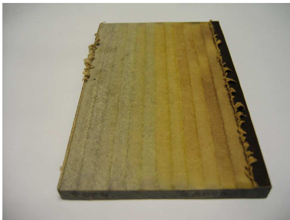
Obr. 35. Destička reaktoplastu plněného papírem, čtyřbřítý nástroj
