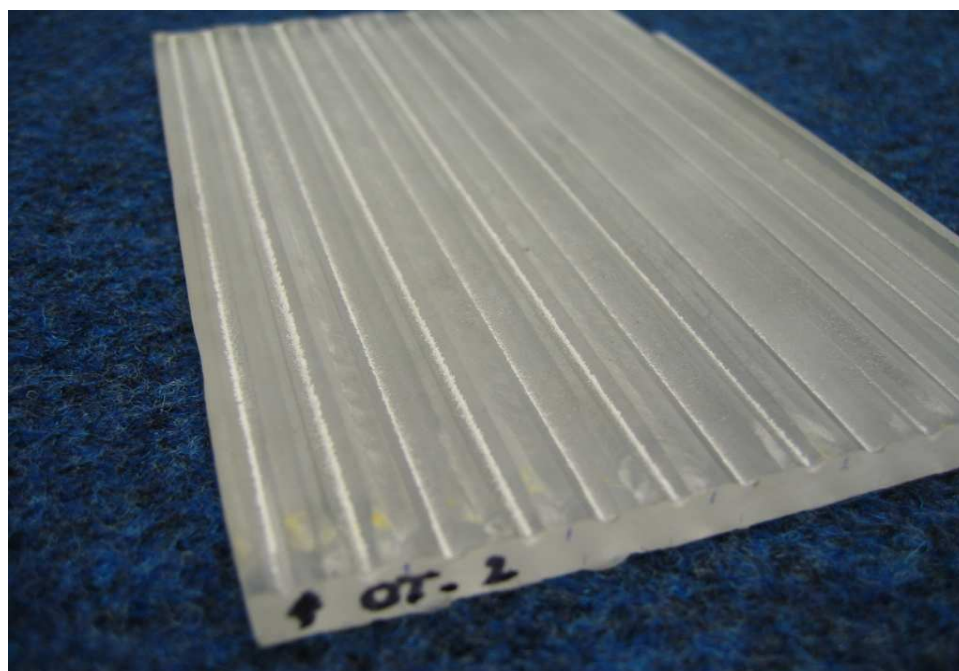
Obr. 29. Destička z PMMA frézovaná dvoubřitým nástrojem
