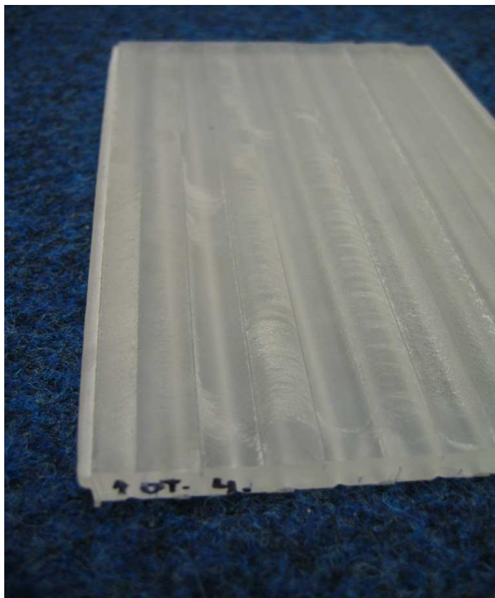
Obr. 31. Destička z PMMA frézovaná čtyřbřítým nástrojem
