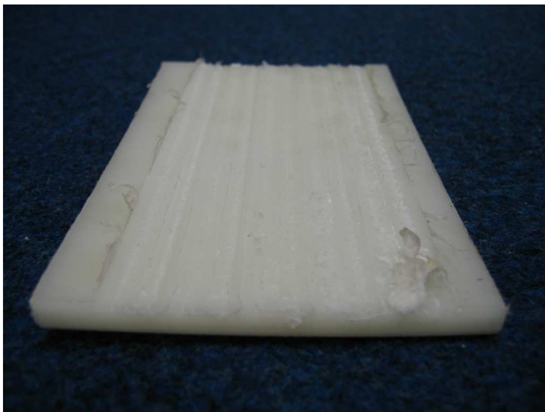
Obr. 56. Destička PP frézovaná dvoubřítým nástrojem
