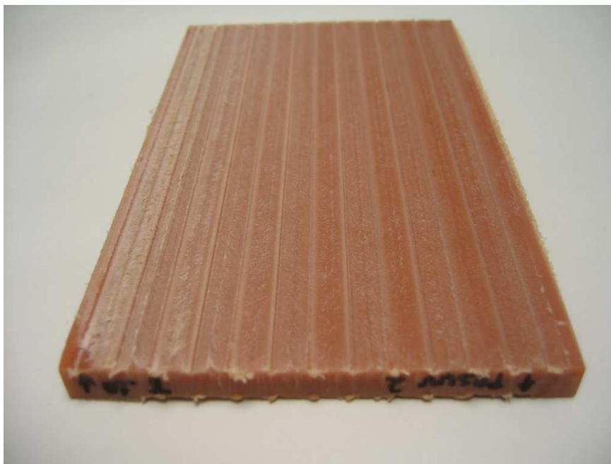
Obr. 25. Destička z PVC frézovaná dvoubřítým nástrojem
