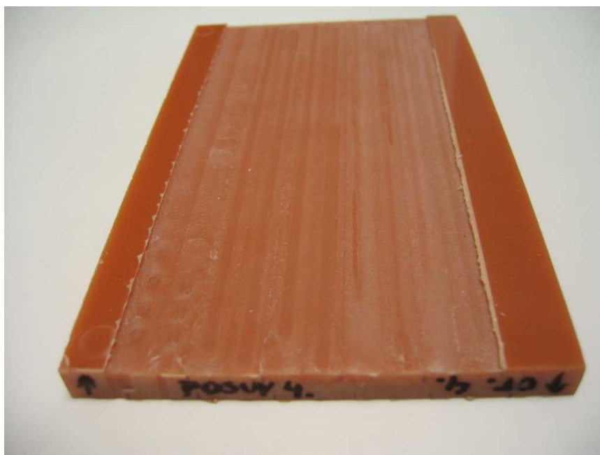
Obr. 43. Destička z PVC frézovaná čtyřbřítým nástrojem
