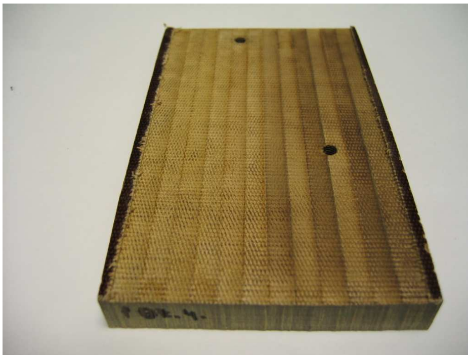
Obr. 37. Destička reaktoplastu plněná textilem, čtyřbřítý nástroj
