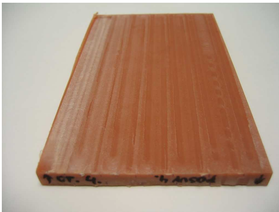
Obr. 27. Destička z PVC frézovaná čtyřbřítým nástrojem
