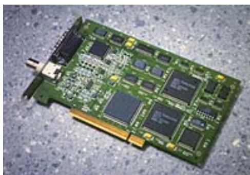
Obr. 14 DT3155 Přesná monochromatická digitalizační karta pro sběrnici PCI
