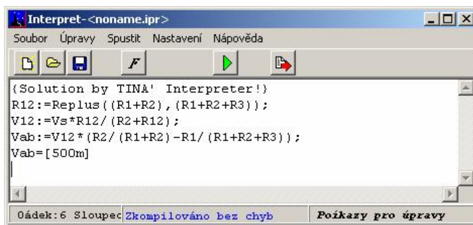
Obr. 24 Řešení pomocí interpretu v programu Tina
