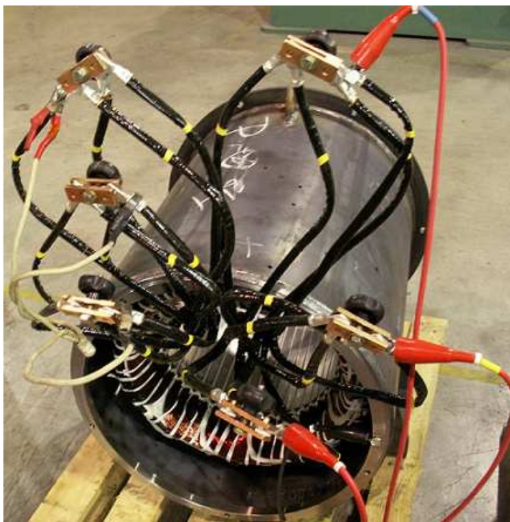
Obr. 16. Zapojení statoru do hvězdy a zkušebních vývodů.
