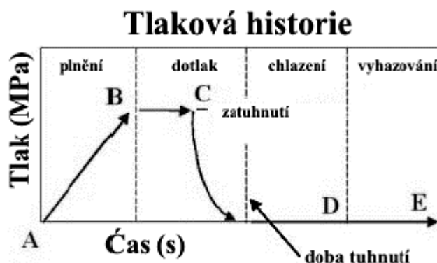
Obr. 14. Průběh tlaku v procesu vstřikování (9)
