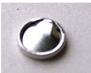
Obr. 46. Hliníková pánvička uzavřena hliníkovým víčkem
