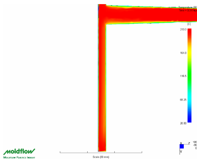
Obr. 89. Teplotní profil celého vzorku vstřikovaného rychlostí 100 mm/s v čase 0,317s
