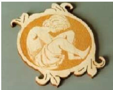
Obr. 6. Laserové značení dárkových předmětů: dřevo, popsáno a vyříznuto laserem (8)
