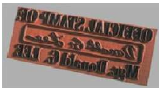
Obr. 10. Hluboké gravírování laserem: 2D-gumové razítko (8)
