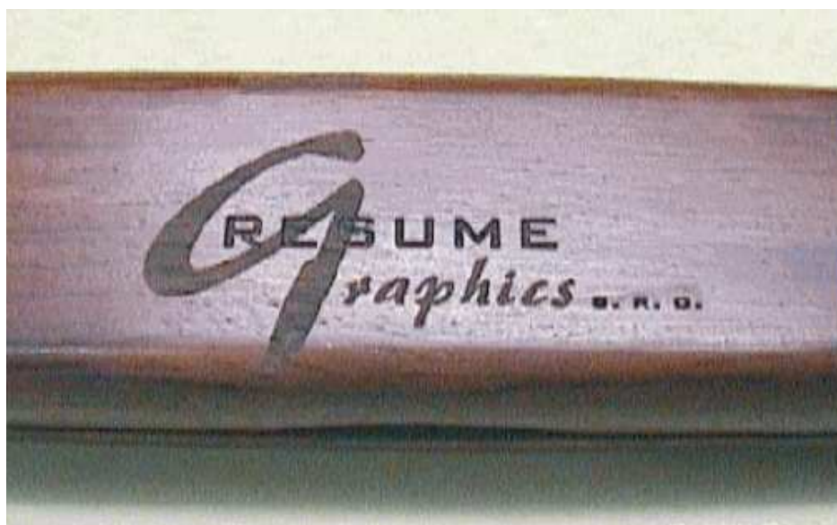
Obr. 9. Laserové značení dárkových předmětů: dřevo, popsáno laserem (8)
