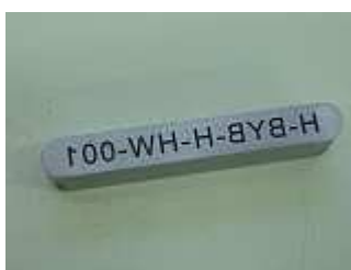
Obr. 8. Hluboké gravírování laserem: Plast (8)
