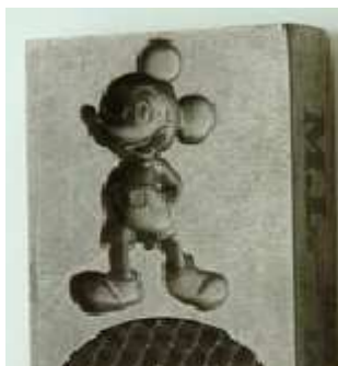
Obr. 7. Hluboké gravírování laserem: 3D-ocelová forma (8)
