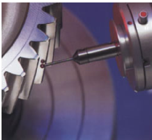
Obr. 14. Příklady měření tvaru evolventy sondou na měřícím centru
