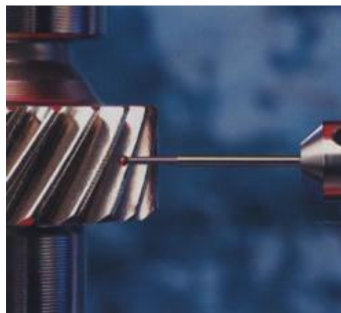
Obr. 14. Příklady měření tvaru evolventy sondou na měřícím centru
