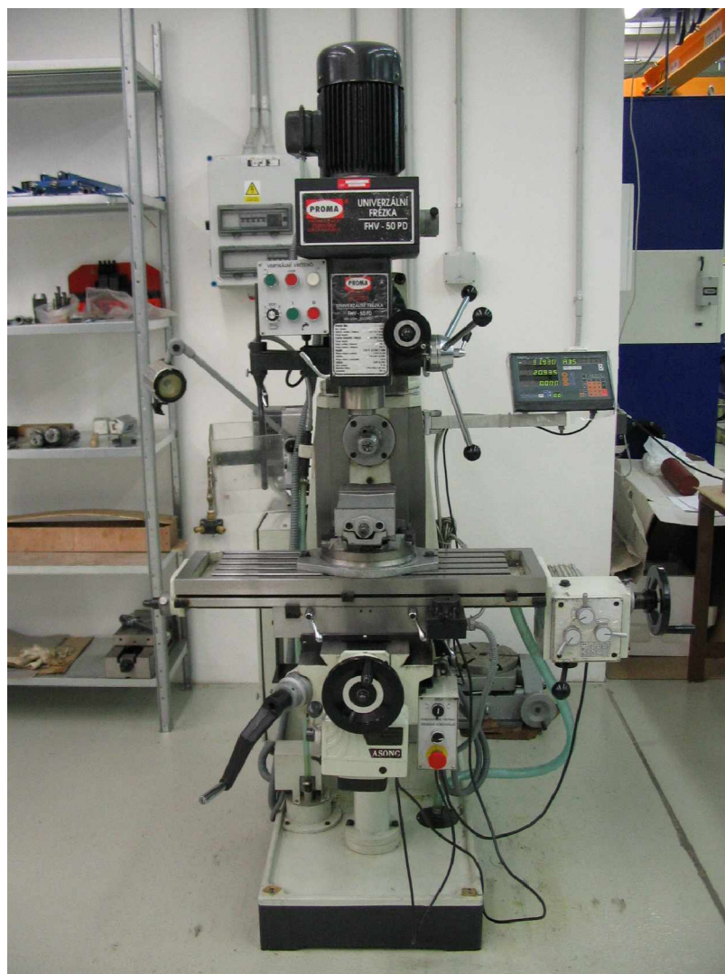
Obr. 14. Univerzální frézka s digitálním odměřováním FHV-50 PD
