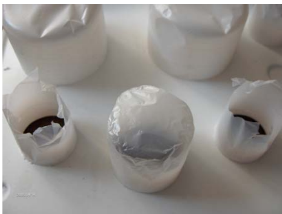
Obr. 22 Prasklé kalíšky menších průměrů
