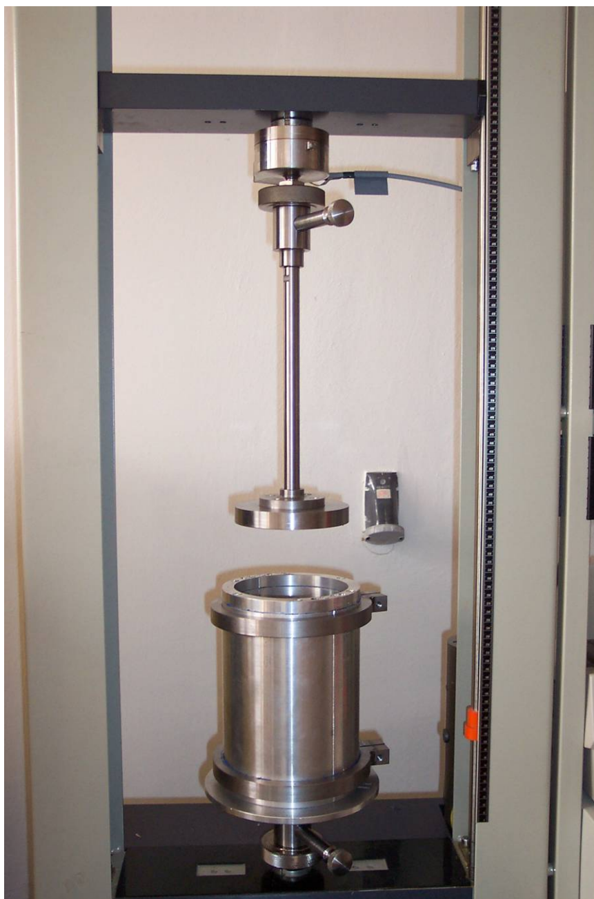
Obr.31. Testovací válec upevněný na tahovém zařízení
