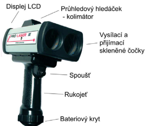
Obr. 14. Laserový měřič rychlosti ProLaserIII
