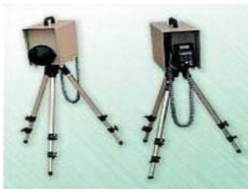
Obr. 20. Radarový měřič rychlosti Ramer 7M-VB
