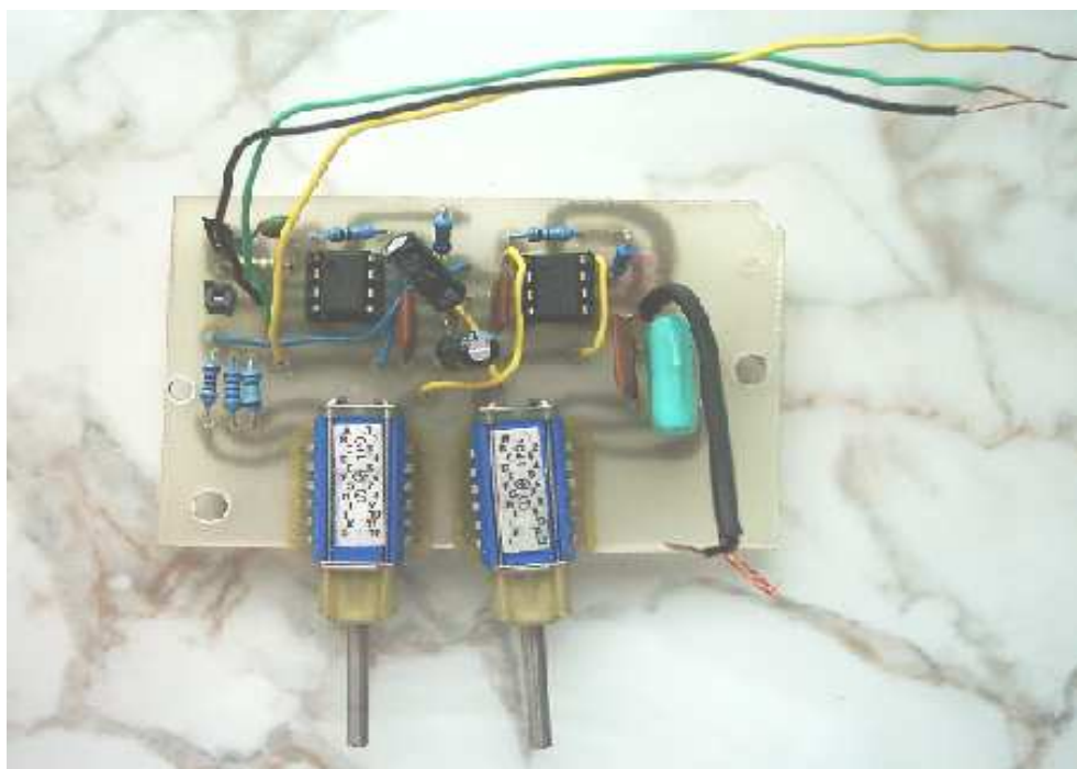
Obr. 28. Osazený plošný spoj zesilovače
