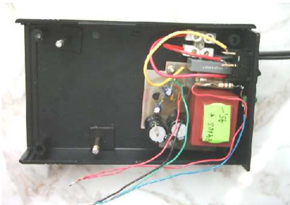
Obr. 27. Montáž plošného spoje napájecího zdroje.
