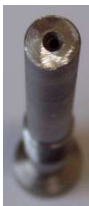
Obr. 29. Otvor v konduktoru pro vložení hrotu
