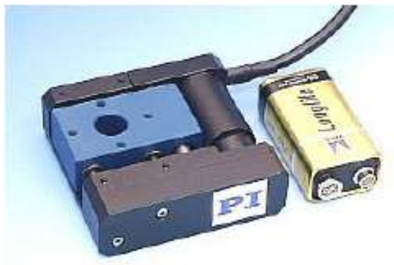
Obr. 32. Mikroposuv v porovnání s baterií
