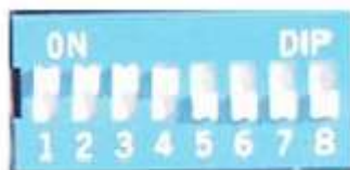
Obr. 15. přepínač nahoře - ON přepínač dole – OFF
