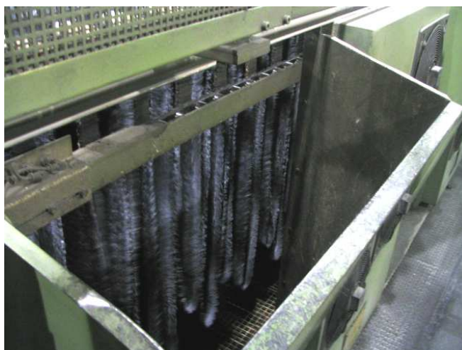
Obr. 20. Pláсты směsi zavěšené na tyčích v chladicím zařízení
