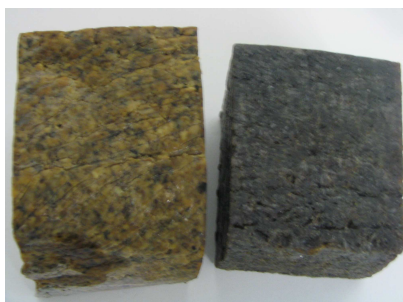
Obr. 23. Srovnání kaučuků PK SIR 20SED– důsledek krystalizace
