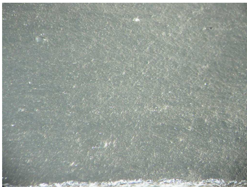
Obr.4 Základ směsi B (B2)– přehřev plastikátu směsi B-460 (1-B460) na teplotu T = 20^{\circ}\text{C} s následným přehřevem základu směsi B 460 (2-B460) na teplotu T = 40^{\circ}\text{C}
