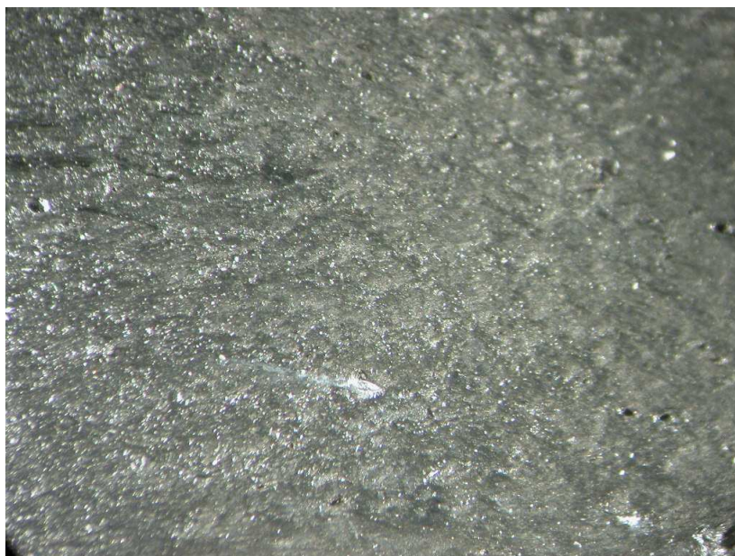
Obr.2 Plastikát směsi B(B1) předeheřtý na teplotu T = 40^{\circ}\text{C}
