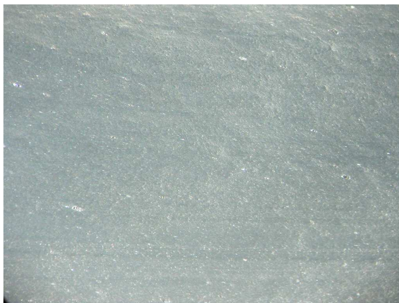
Obr.6 Základ směsi B – předeřev plastikátu B1 na teplotu T = 40\text{ }^{\circ}\text{C} s následným předeřevem základové směsi B2 na teplotu T = 60\text{ }^{\circ}\text{C}
