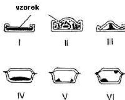
Obr. 17. Uložení vzorku v misce při DSC analýze, pouze vzorek I a IV je správně uložen [27].
