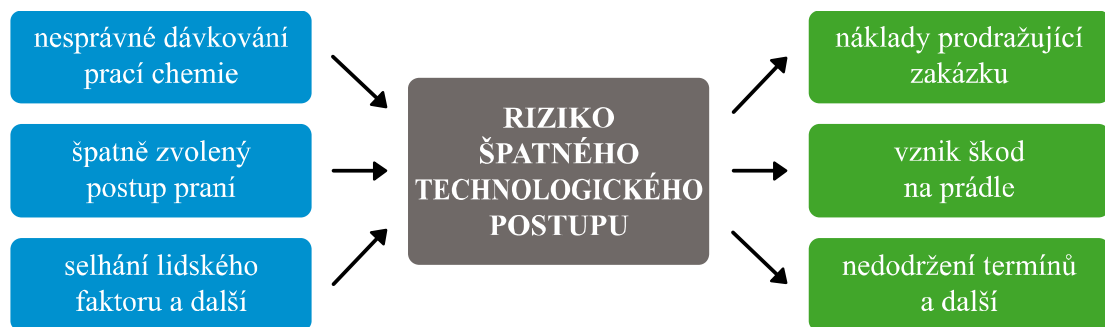
Obr. 8. Příčiny a následky rizika špatného technologického postupu
