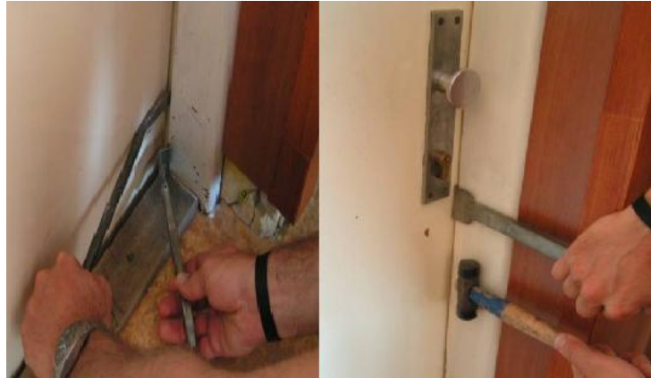
Obrázek 18 Otevření pomocí lopatky [Zdroj: autor]
