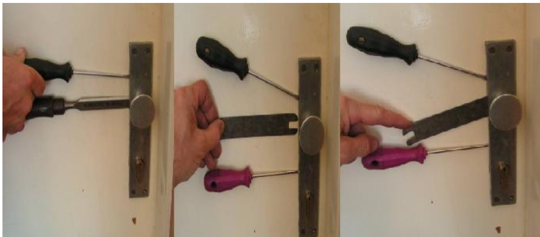
Obrázek 19 Otevření pomocí otvíracího pásku [Zdroj: autor]
