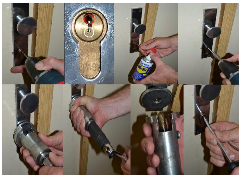
Obrázek 21 Vytržení válečku vložky [Zdroj: autor]
