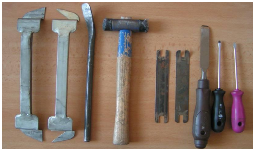
Obrázek 8 Sada pro otevírání zabouchnutých dveří [Zdroj: autor]
