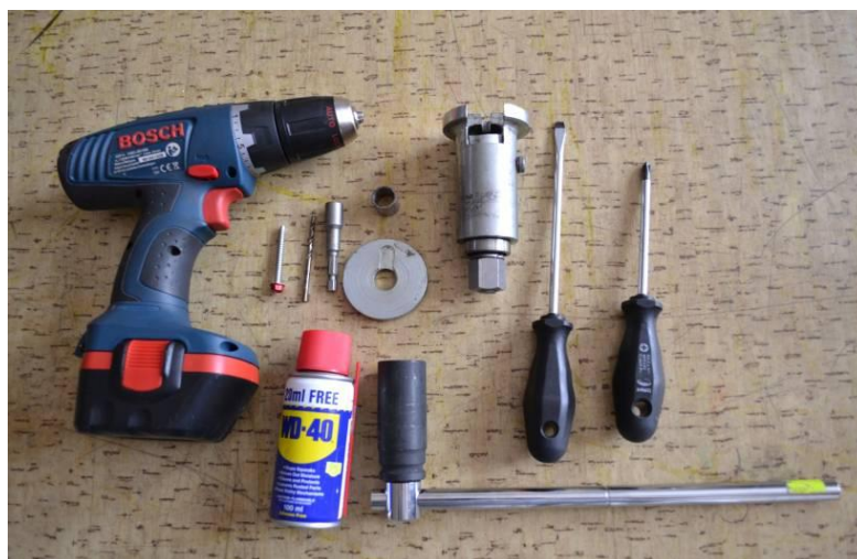
Obrázek 9 Nářadí pro vytržení válečku cylindrické vložky [Zdroj: autor]
