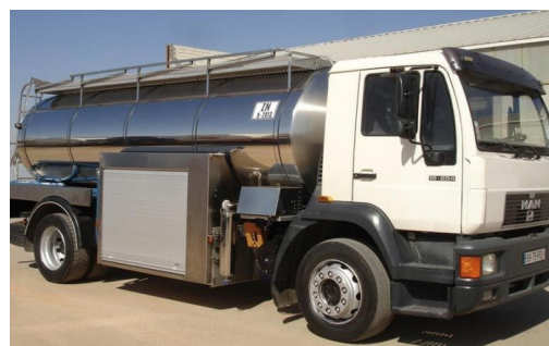
Obrázek 3.4 Cisterna pro dopravu a svoz mléka Parcisa [Zdroj: 22]
