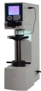
Obr. 3 Stolní tvrdoměr Brinell série B-3000 [22]
