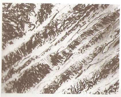
Obr. 14 Bainitická struktura eutektoidní oceli s 3,5% manganu.
