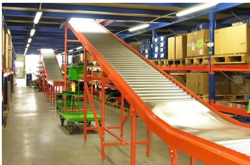
Obr. 8 Gravitační válečková doprava
