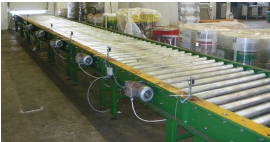
Obr. 9 Dopravník s hnanými válečky
