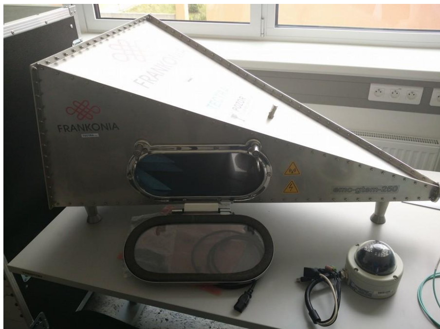
Obr. 20: GTEM cela FRANKONIA emc-gtem-250
