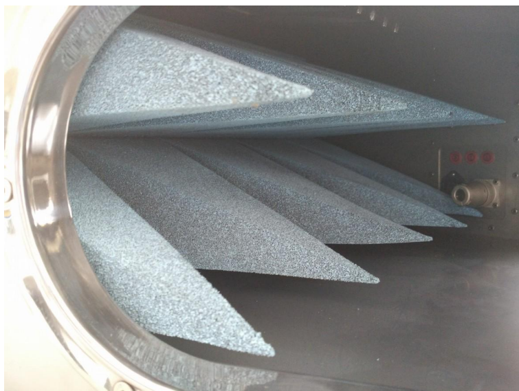
Obr. 10: Absorpčné ihlany A vo vnútri GTEM cely
