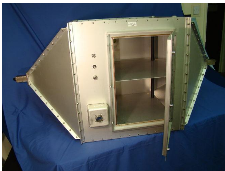
Obr. 8: TEM cela - tzv. Crawfordova komora[13]
