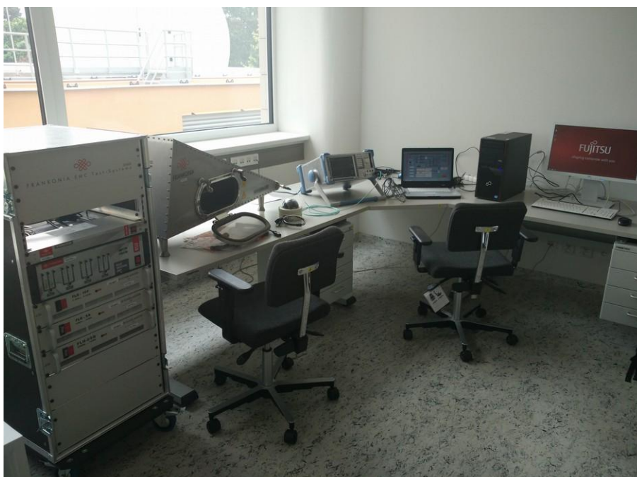
Obr. 18: Pracovisko merania EMC s využitím GTEM cely
