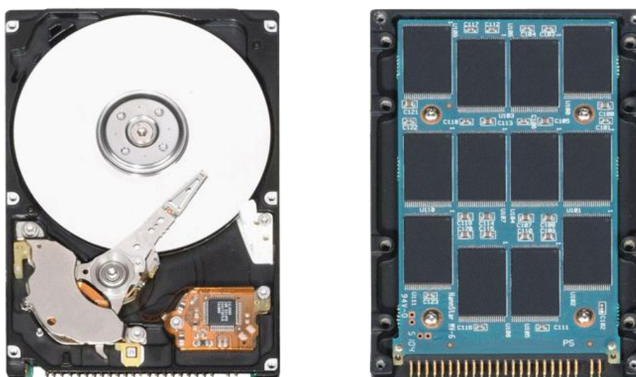
Obr. 9. Porovnání mechanického a SSD disku [13]
