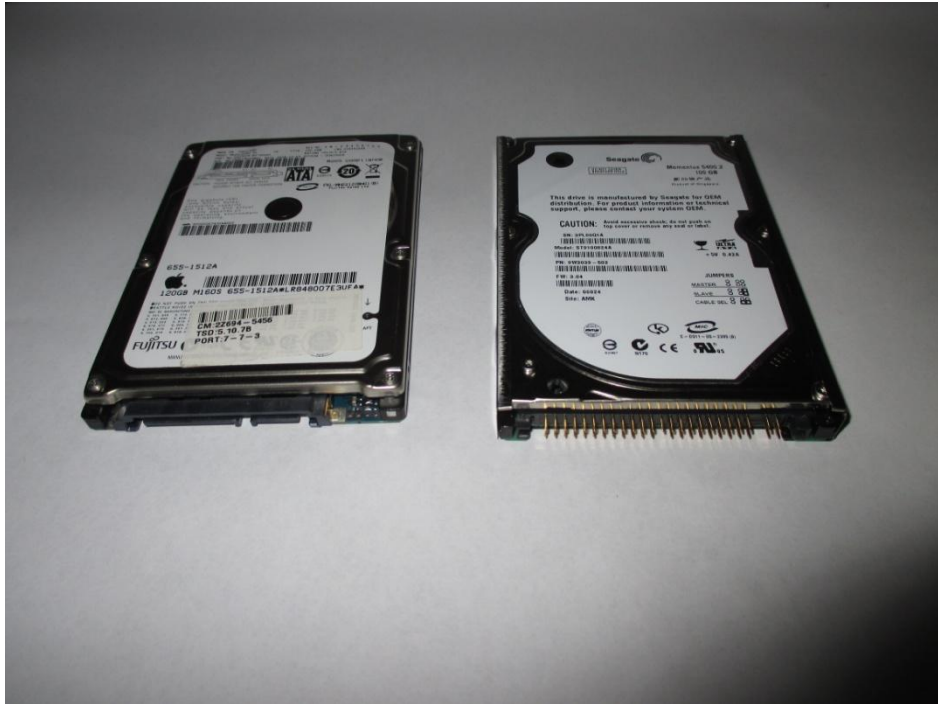
Obr. 28. Disky s konektivitou SATA a IDE
