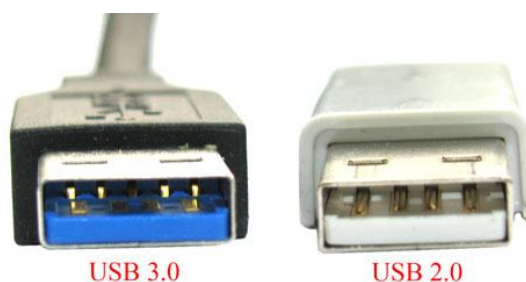
Obr. 8. Rozdíly v konektoru USB 3.0 a USB 2.0 [13]
