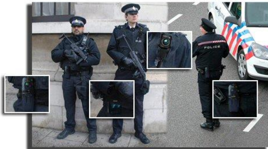
Obrázok 5: Príklad pripnutia kamery HCR 700HD na uniformu [19]
