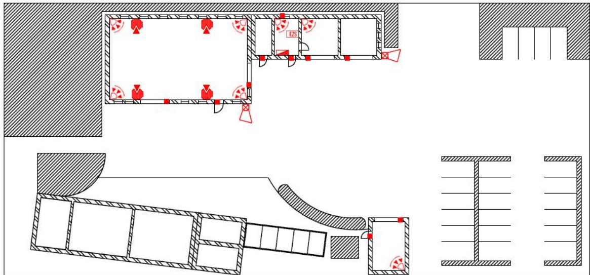
Obrázok 30: Návrh nového PZTS systému – lacnejší variant [zdroj: autor]
