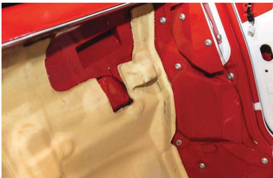
Obr. 14. Montáž balistické ochranné vrstvy zevnitř karoserie 35
