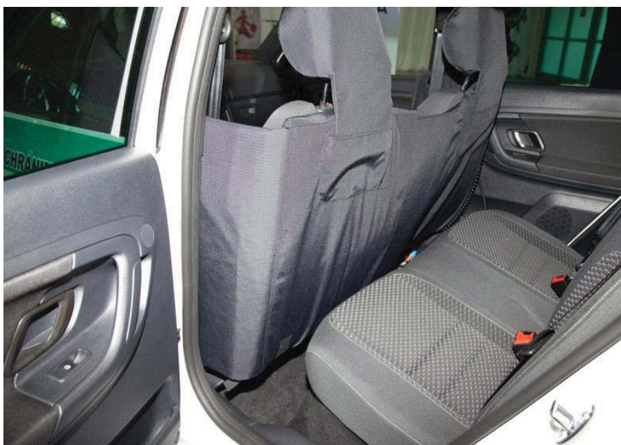
Obr. 16. Dodatečná montáž balistické ochrany na interiér 37
