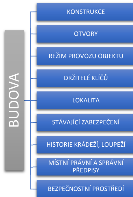
Obrázek 2: Posuzované prvky – budova dle ČSN CLC/TS 50131-7 [zdroj: autor]
