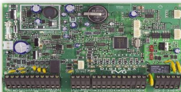
Obr. 10 Technické řešení ústředny PZTS [19]
