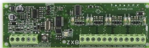
Obr. 11 Příklad expandéru zón [19]
