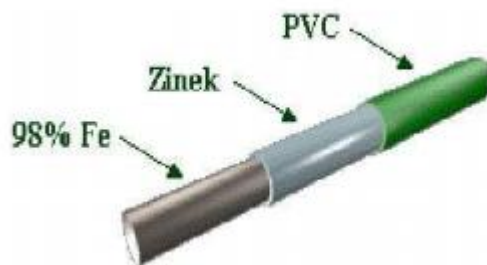
Obr. 5 Plotový prut opatřený zinkem a PVC povrchem [8]
