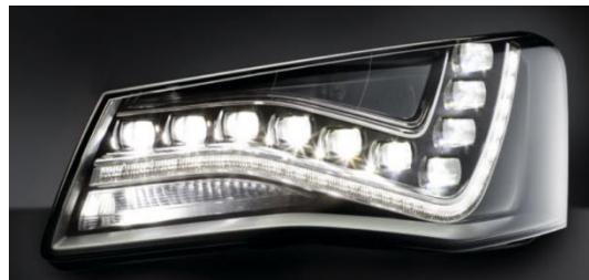
Obrázek 12 Full LED světlomety s funkcemi AFS, Audi A8 (HELLA KGaA Hueck & Co., 2014)
