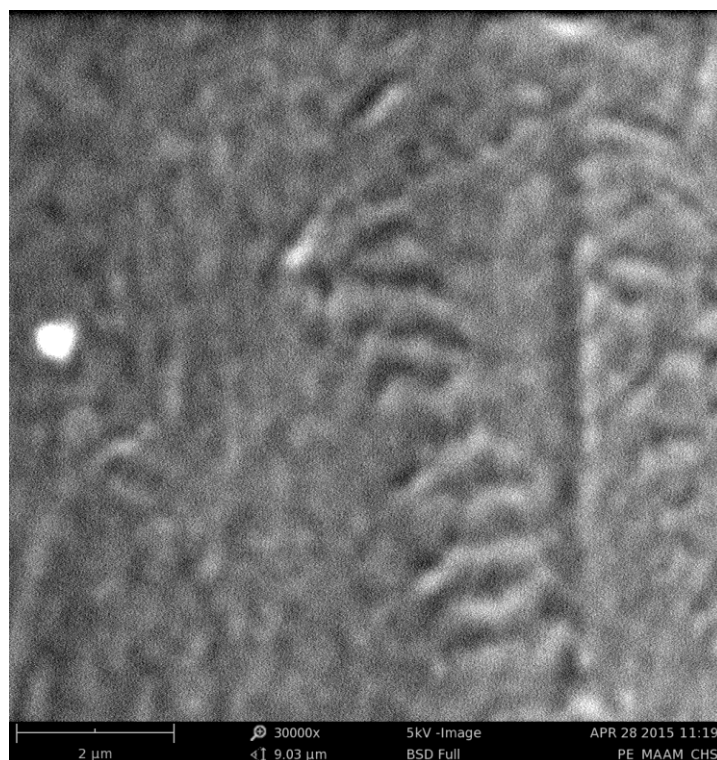
Obrázek 18: SEM, PE opracovaný + MAAM + CHS – 30 000 × zvětšeno
