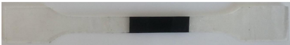
Obrázek 25 Testovací PU lopatička s aktivní vrstvou s nanotrubic
