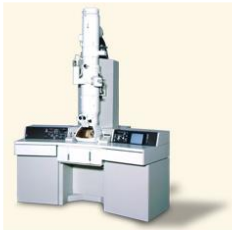
Obrázek 12 Transmisní elektronový mikroskop – Jeol Jem 2010 [28]
