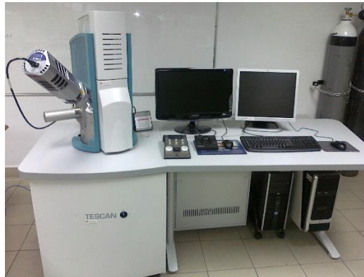
Obrázek 13 Skenovací elektronový mikroskop – Tescan Vega 3 Lmu [29]
