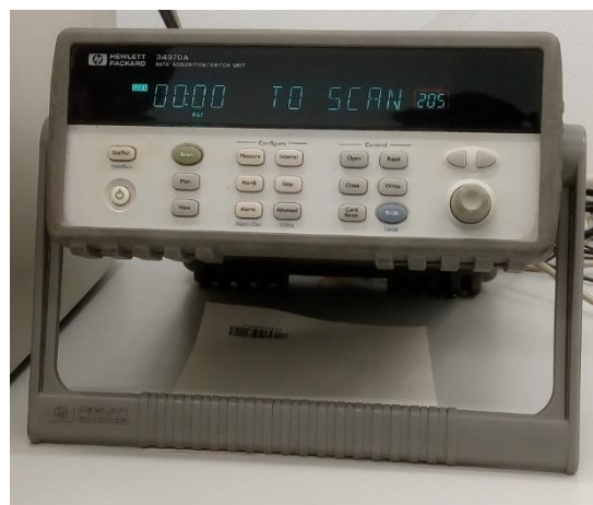
Obrázek 19 Měřicí ústředna Hewlett Pac- kard 34970 A opatřena kartou Hewlett Pac- kard 34901 A (20 kanálový multiplex)
