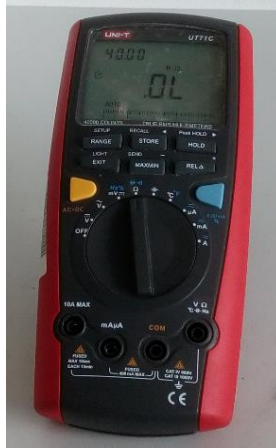
Obrázek 11 Digi- tální multimetr UNI – T UT 71C
