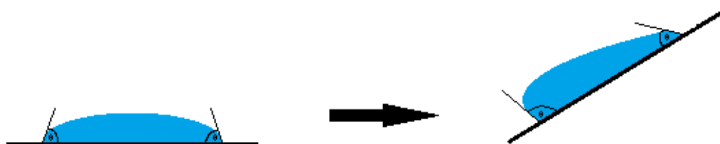
Obrázek 7 - Vliv hystereze na hodnoty kontaktního úhlu po naklonění
