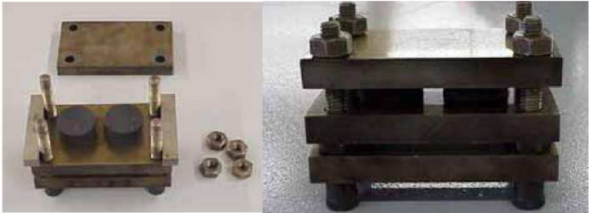
Obr. 23. Přípravek pro experiment trvalé deformace v tlaku [48]
