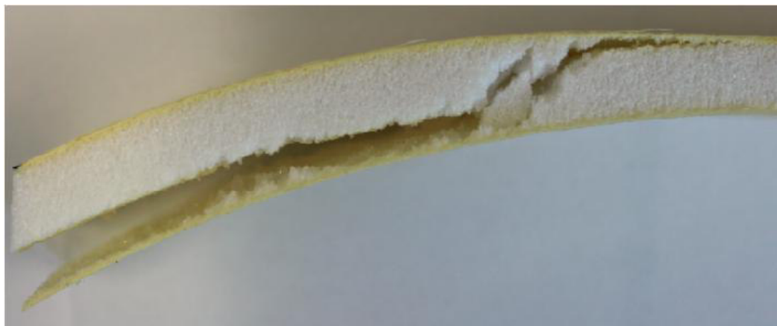
Obr. 69. Ukázka deformovaného vzorku po čtyřbodové zkoušce (jádru 10 mm)
