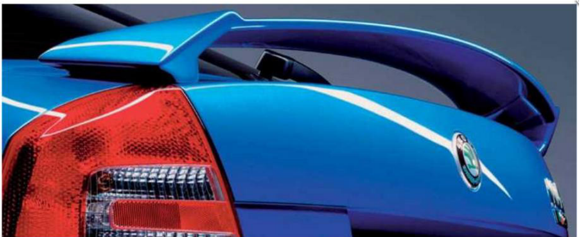
Obr. 37. Sendvičová konstrukce použita k výrobě zadního křídla automobilu [29]
