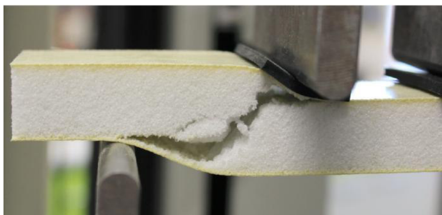
Obr. 64. Smykové porušení jádra přímého panelu s jádrem 20 mm
