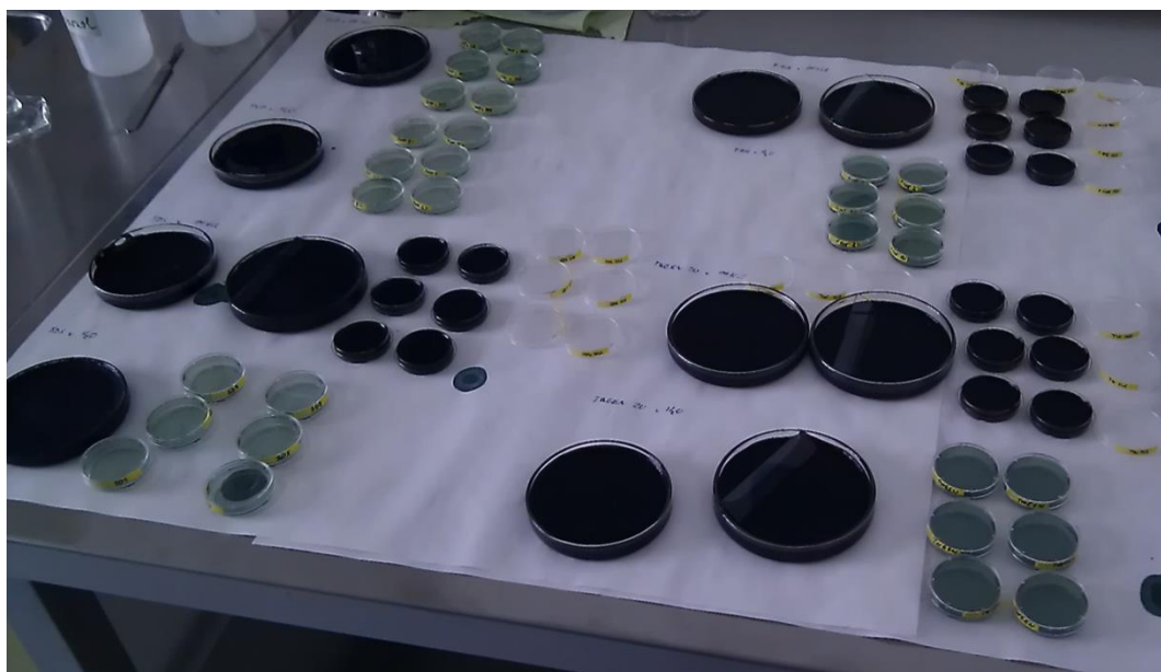
Obrázek 32 – polyanilinová disperze vzniklá polymerací v polystyrenových a skleněných Petriho miskách. Po výplachu disperze zůstává na substrátech vrstva PANi filmu
