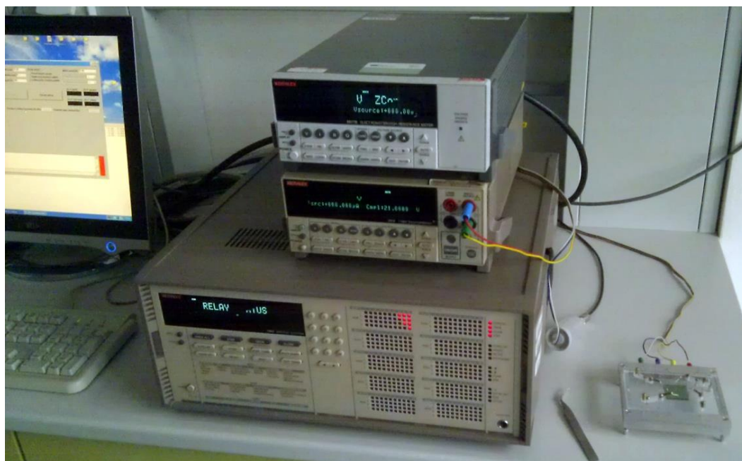
Obrázek 37 – fotografie aparatury pro měření konduktivity PANI filmu čtyřbodovou metodou (osobní počítač, zdroj, scanner, elektrometr a stůl s elektrodami)
