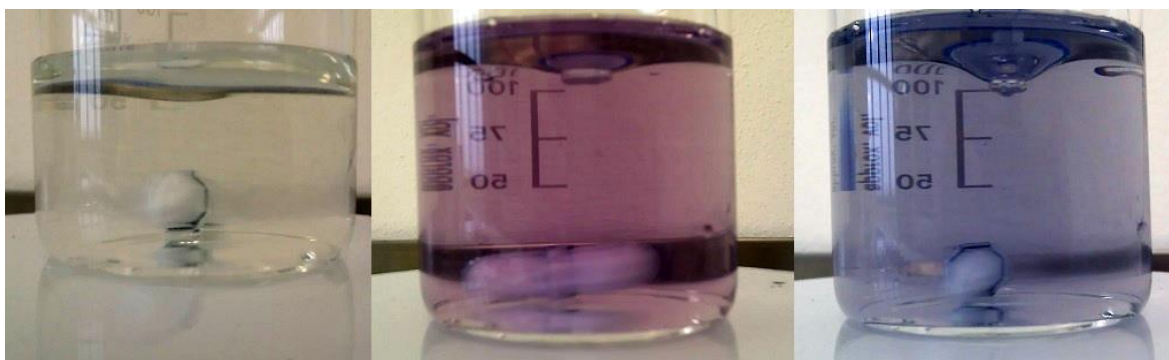
Obrázek 33 – barevné změny reakční směsi složené z roztoků AH a APS; vlevo 0,2 M roztok AH; uprostřed 10 s po přidání roztoku APS; vpravo 20 s po přidání roztoku APS
