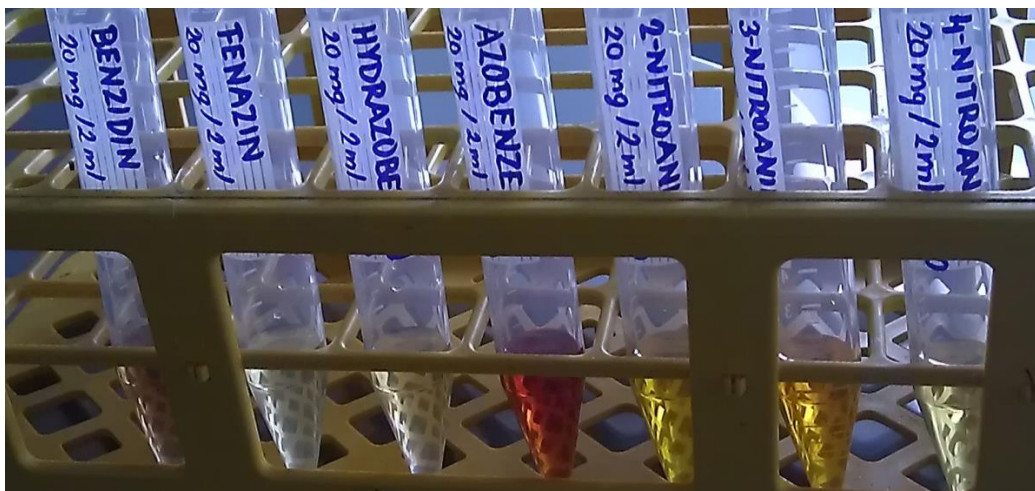
Obrázek 17 – rozpuštěný BENZ, FEN, HB, AZO, 2-NA, 3-NA a 4-NA v DMSO
