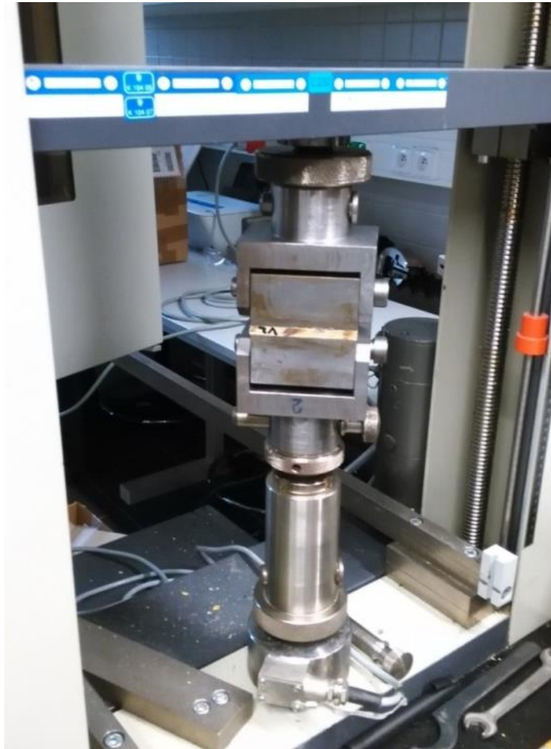
Obr. 56: Zkušební zařízení pro odtrhovou zkoušku
