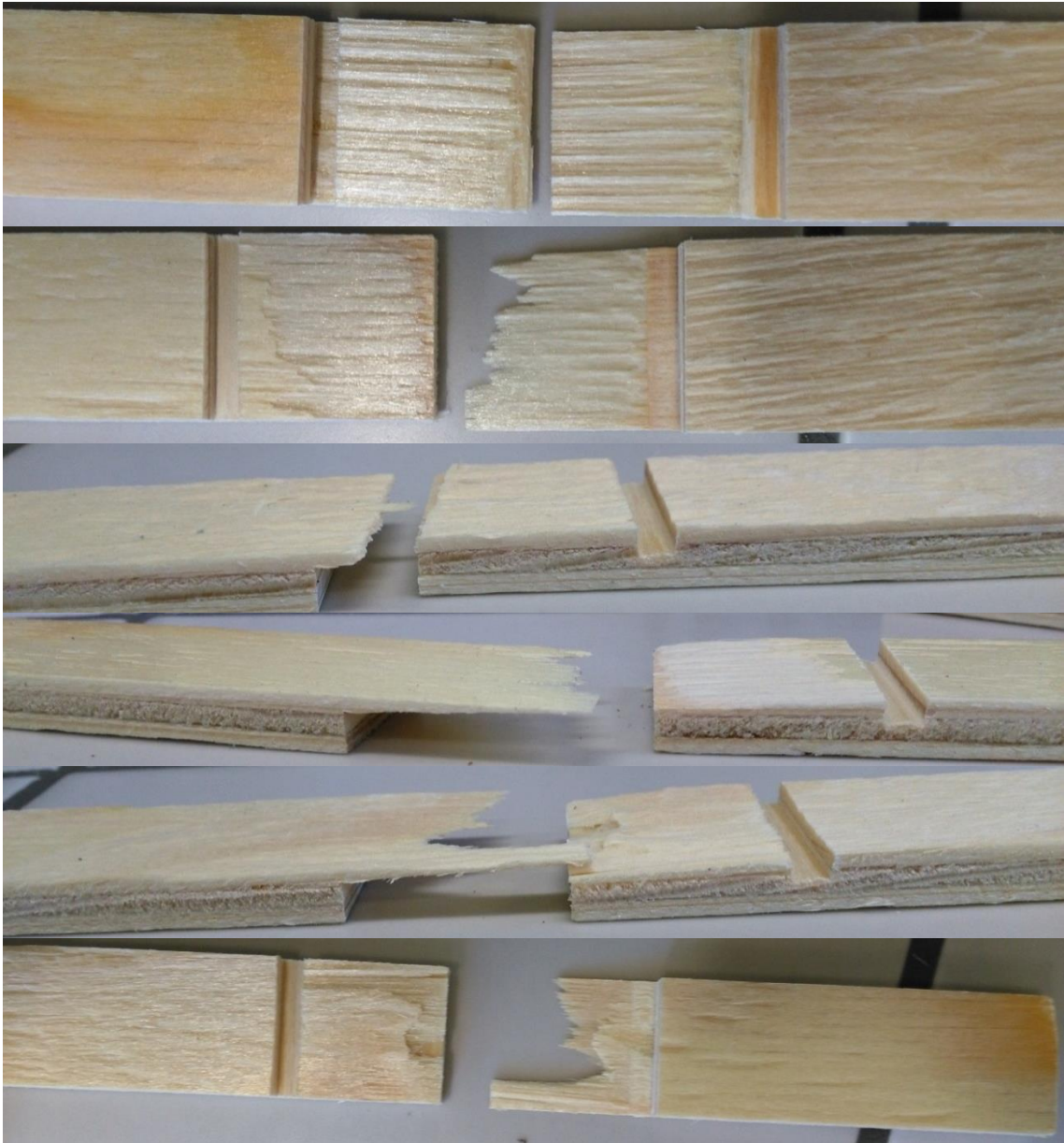
Obr. 77: Detaily nesprávného porušení vzorku
