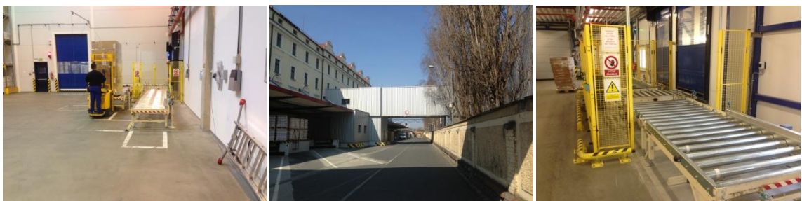
Obr. 15 Dopravníky a logistický krček vedoucí z meziskladu do výrobní haly (vlastní zpracování)
