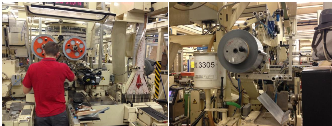
Obr. 10 Metalizovaný papír a odtrhací páska na balicím stroji (vlastní zpracování)
