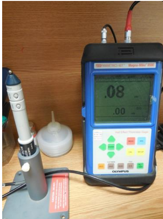
Obr. 32 Přístroj na měření tloušťky stěny (Vlastní zpracování)
