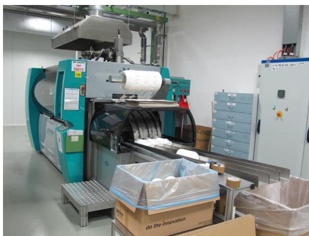
Obr. 25 Tvarování víček (Interní materiály)
