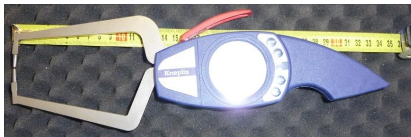
Obr. 35 Číselníkový úchylkoměr (Vlastní zpracování)
