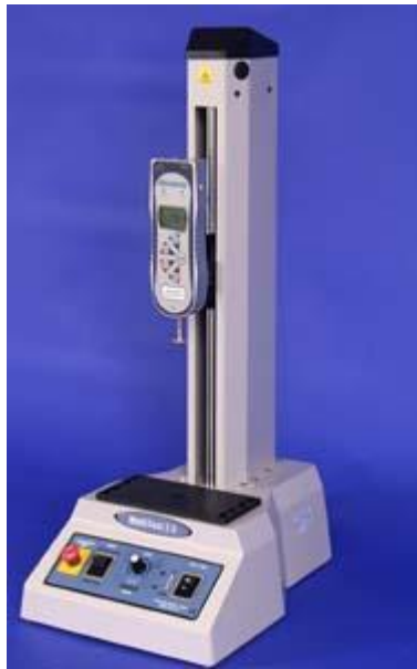
Obr. 36 Přístroj pro měření vzpěrové pevnosti (Interní materiály)
