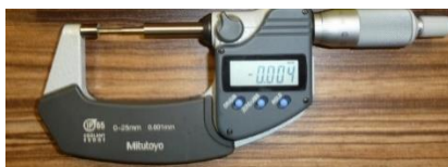
Obr. 38 Digitální mikrometr (Vlastní zpracování)
